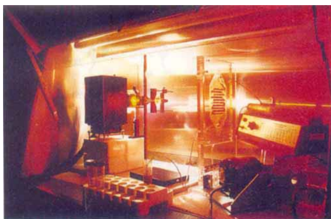
Abb. 10. Strömungsapparatur zur Blutsterilisation (Baylor Research Foundation)[73b,83]. Oben: Prinzipskizze: A) Laserlichtgenerator, B) Strömungszelle, C) Pumpe, D) Auffanggefäß, E) Lichtmeßgerät. Unten: Bestrahlungsapparatur mit rotem Laserlicht in Betrieb.
